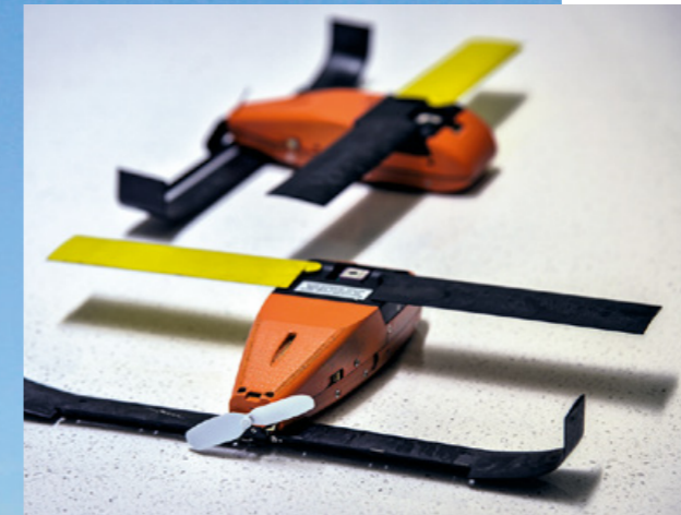
Die Perdix-Mikrodrohnen der U.S. Navy bilden einen Schwarm, der Ziele erkundet und überwachen kann. Das System gilt als teilautonom.
