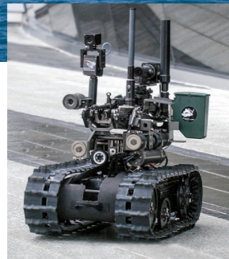
Das Special Weapons Observation Reconnaissance Detection System (SWORDS) ist eine bewaffnete Version des EOD-Roboters TALON
